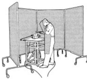
Fig. 4: Mampara de separación
