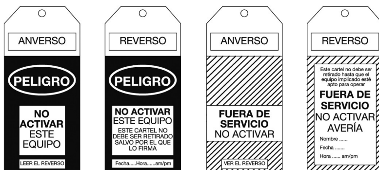
Ejemplos de carteles que pueden colocarse sobre los dispositivos de maniobra para prohibir su accionamiento.
